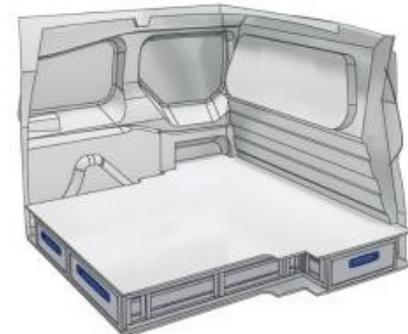
**L** 1492mm **H** 176mm **D** 1270mm **KG** 62kg
